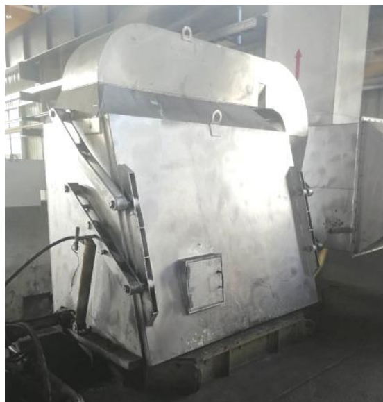
图 9.2.3-1 现有熔化炉烟气密闭式集气罩收集系统示意图
