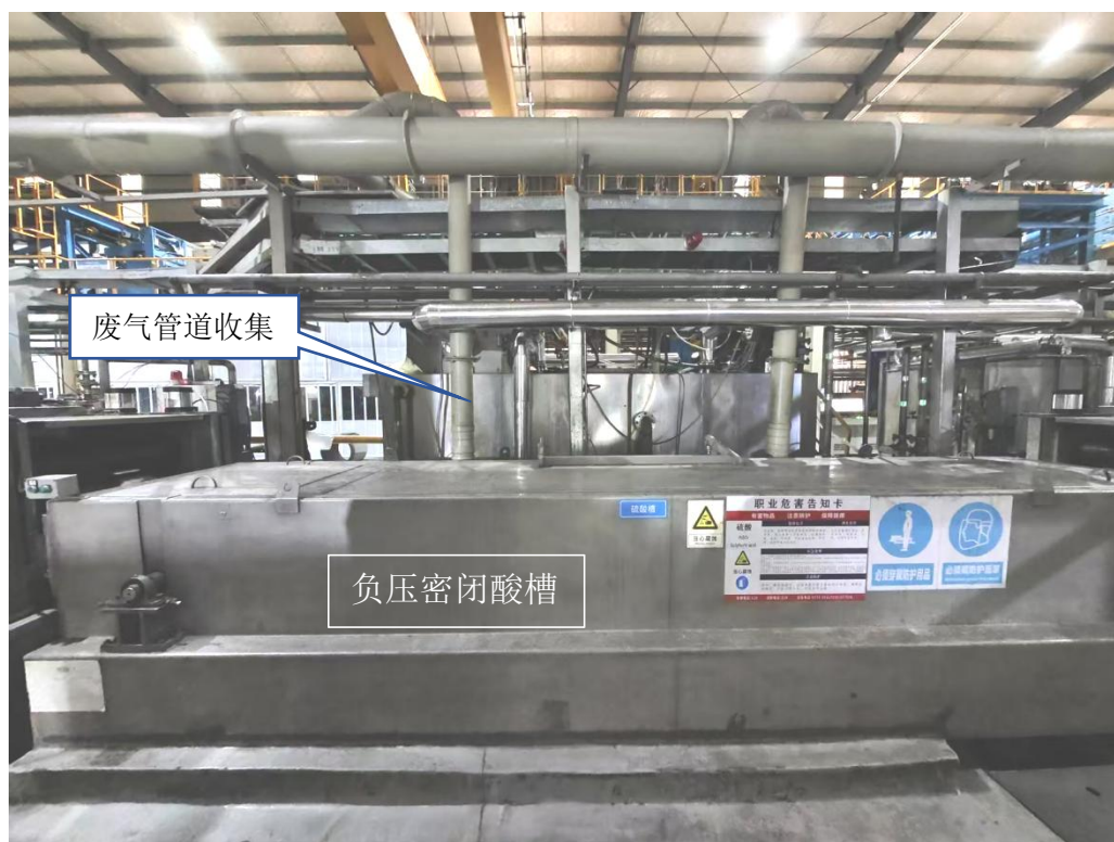
图 9.2.3-2 清洗酸雾废气密闭收集示意图
